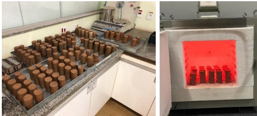
Figura 2. (a) Preparação dos corpos de prova e (b) Queima dos corpos de prova.
